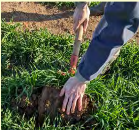
Prélèvement à la bêche jusqu'à 20cm de profondeur
