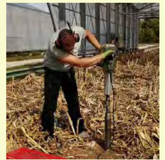
Prélèvement mécanique d'une carotte de sol
